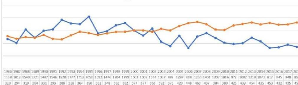
Die rote Linie markiert das gegenwärtige Ausbauziel für den Elbe-Lübeck-Kanal. Wie man sehen kann, wurden die Frachtmengen, für die der Kanal ertüchtigt werden soll, noch 2008 mit den zur Zeit fahrenden Schiffen auch ohne Ausbau erreicht.
